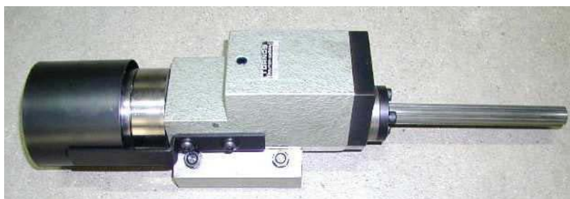
un esempio: AS25/8 fresatore frontale originale
